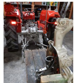
Tiefe Einblicke in die Wirren der Ferguson-Hydraulik nahm der Vorstand gemeinsam mit seiner Frau Dania, um ein paar defekte O-Ringe zu tauschen. Leider steckte der Teufel wie immer im Detail und so sind die Hofbauer's nun schon im Auf- und Abbau des Hydraulikblocks geübt. Aber nun hebt der 135er wieder tadellos und das nächste Oldtimerpflügen kann kommen. In diesem Sinne – bleibt mir gesund und wir freuen uns auf ein Wiedersehen! Eure Vorstandschaft.
