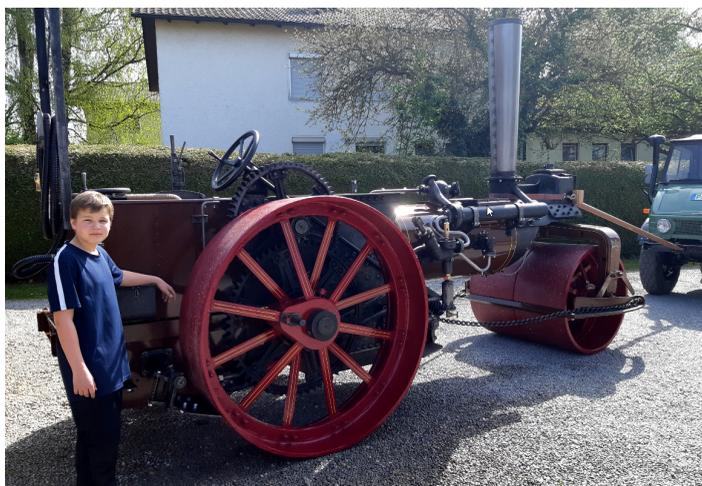
Hofbauer's Dampfwalze lässt sich inzwischen schon wieder als solche erkennen und der Kessel wurde bereits einer ersten Druckprobe unterzogen. Leider fehlt zum Fahrvergnügen noch die komplette Maschine, also Zylinderblock, Kolben, Kurbelwelle, Getriebe usw., das nun alles als nächstes schrittweise aufbereitet wird.
